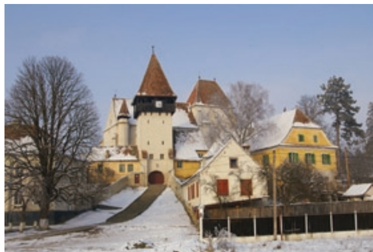
Baaben. Turmlose Saalkirche aus dem 14.-15. Jahrhundert. Anfang des 16. Jahrhunderts wurden dem Chor drei Wehrgeschosse aufgemauert, die über ein Rundtürmchen mit Wendeltreppe zugänglich sind. Von den drei Türmen des im Westen verdoppelten Verteidigungsringes blieb der fünfgeschossige Torturm im Süden erhalten.
